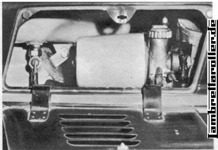
Im linken Bild ist einmal vorgeführt, wie man den Benzinbahn zu erreichen versuchen muß, wenn man während der Fahrt auf Reserve stellen will. Das geht praktisch nur, wenn man, wie hier, 1,92 m groß ist und entsprechend lange Arme hat. Rechts die geöffnete Seitenklappe enthüllt den Micronic-Filter am Vergaser und den Benzinbahn ohne Wassersack.
