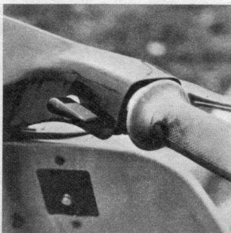
Ein sehr gut durchdachtes Detail: der Blinkerschalter. Leider gibt es ihn bei Hella nur für Anbau an solche Lenkerverkleidungen, für Rohrlenker wäre er aber immerhin auch sehr schön.
